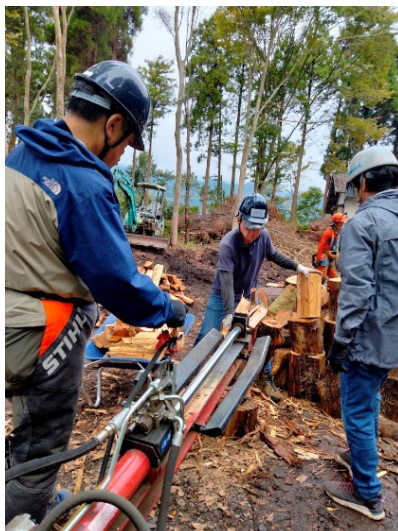
油圧式の薪割機を使えば、硬い木でも簡単に割ることができます
