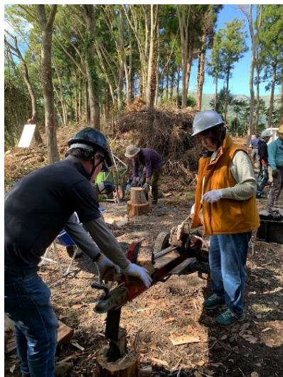
油圧式の薪割機を使えば、硬い木でも簡単に割ることができます
