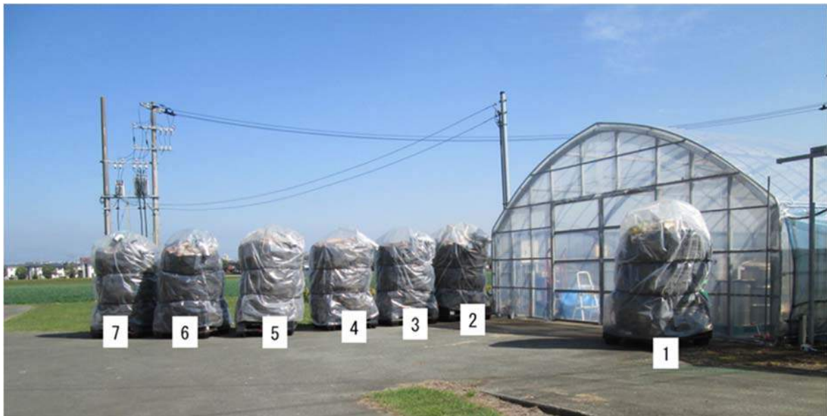
図 簡易送風装置によるウッドバッグ乾燥試験の配置状況
