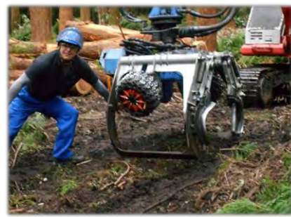
枝落とし・玉切りができます。タイヤ部分にチェーンが巻きついており、回転して丸太を動かし自動で長さを測りカットします。
