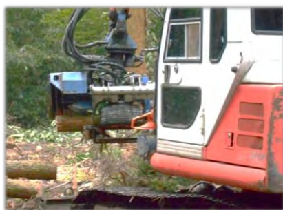
枝落とし・玉切りができます。タイヤ部分にチェーンが巻きついており、回転して丸太を動かし自動で長さを測りカットします。
